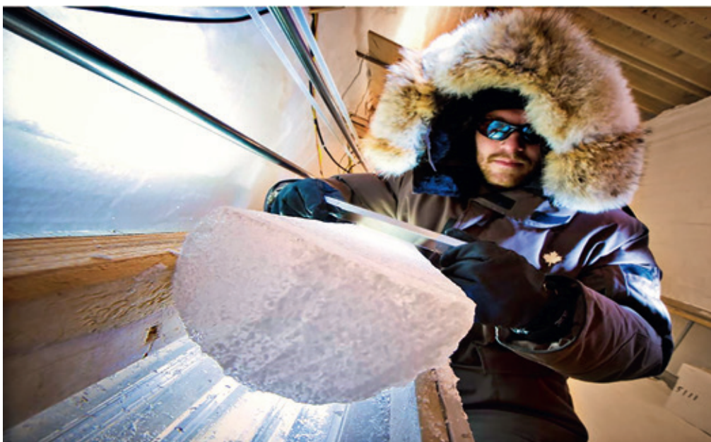
Lektor Bo Vinther, NBI, renser en iskerne overflade inden måling af isens syre-indhold. Indholdet af syre kan afsløre, om der er vulkanske lag i isen.
