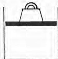
Figur 2.1: Cylinderens indhold er et termodynamisk system, hvor trykket er konstant
