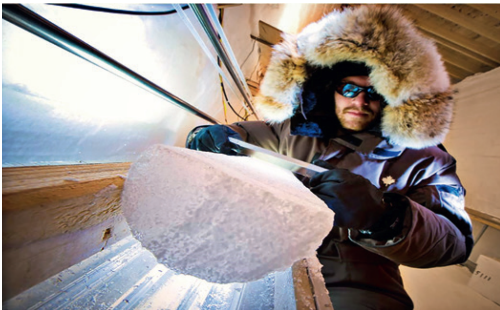
Lektor Bo Vinther, NBI, renses en iskerne overflade inden måling af isens syre-indhold. Indholdet af syre kan afsløre, om der er vulkanske lag i isen.
